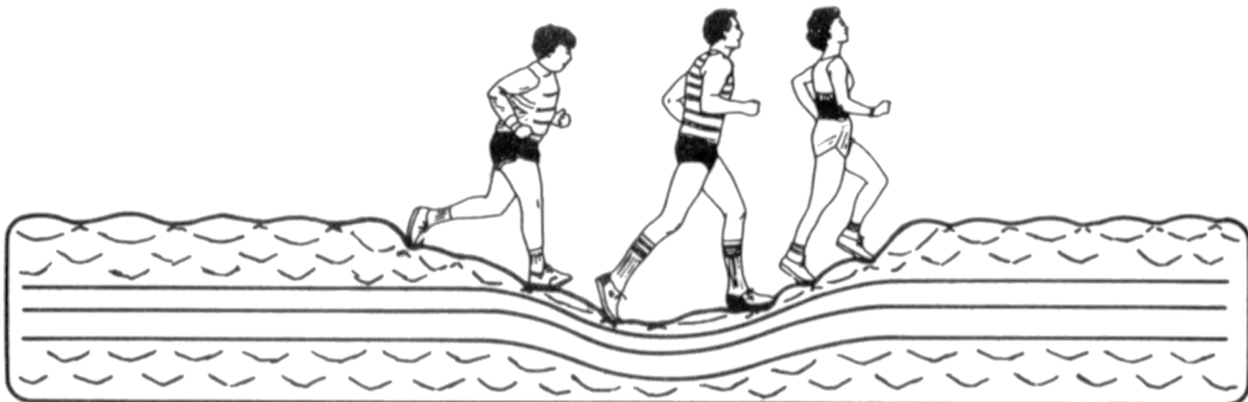
Abb. 3.4 : Anschauliche Erklärung der Wechselwirkung von Selbstphasenmodulation und Dispersion: Bei hohen Leistungen wird die Faser nichtlinear und verhält sich wie eine weiche Matratze; Die schnellen spektralen Anteile werden verlangsamt und die langsameren werden beschleunigt
